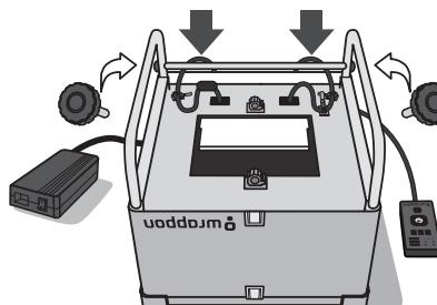
「ACアダプター」と「手元スイッチ」のコードは、「補強棒」と本体の間を通してください。安全のため、「ネジ(2つ)」をしっかりと締めてください。
